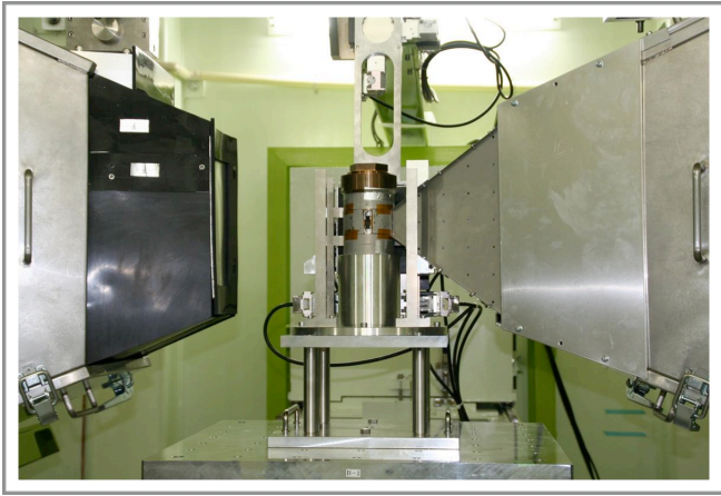
図1. パームキュービック装置を用いた測定の様子。 左側にはradialコリメータ、右側には出射コリメータが付いている。
