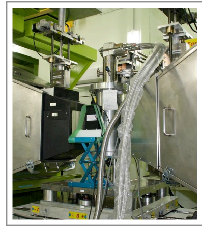
図2. 冷凍機の位置調整の様子。 冷凍機の下流側に置かれた中性子カメラを用いて、試料部を観察しながら位置調整を行う。
